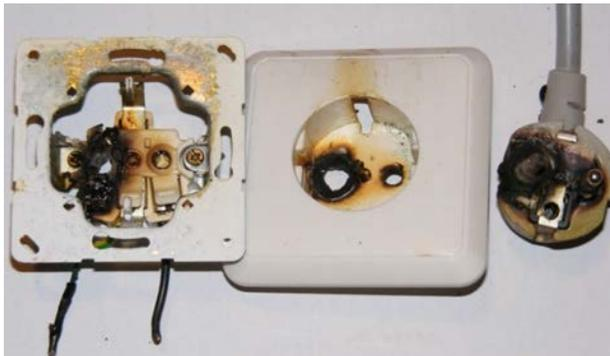
**Abbildung 16: beschädigte Steckdose. An dieser Steckdose war eine Spülmaschine mit 3 kW Nennleistung etwa sechs Jahre lang problemlos betrieben worden. Wegen unangenehmen Geruchs beim Betrieb der Spülmaschine wurde schließlich der Handwerker gerufen.**
