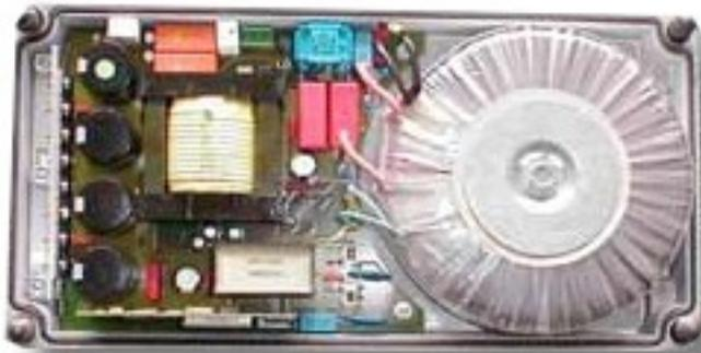
Abbildung 5: Blick in ein geöffnetes Gerät (Dorfmueller DMI 250); rechts der Ringkern-Niederspannungstransformator
